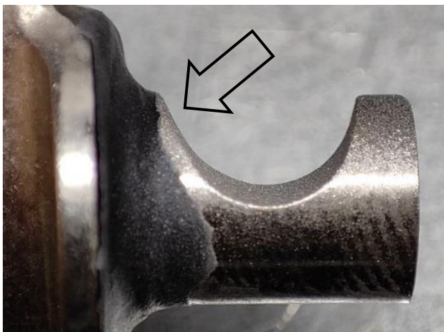
Фото цапфы лопатки с износом паза по стороне ближе к перу лопатки
