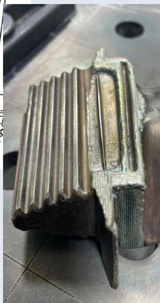
Наплавка торца нижней полки РЛ
