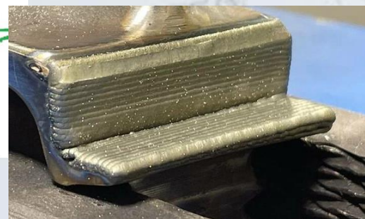
Наплавка пера РЛ
