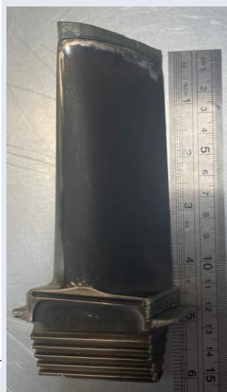
Наплавка гребешков уплотнителей РЛ
